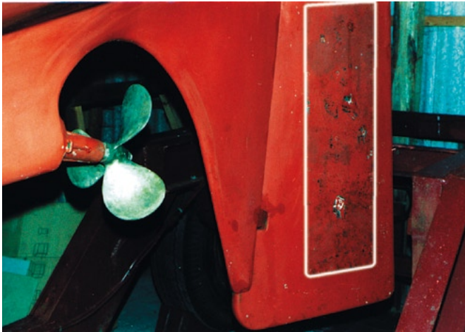
Beispiel einer Teilerdung am Ruder
